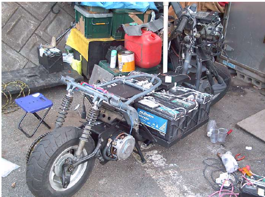
図9 走行用バッテリーは車体左右にフレームを製作し搭載した。
